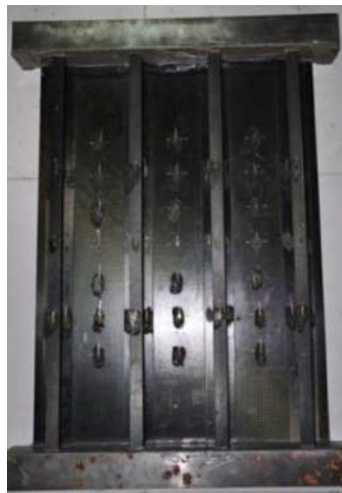
图 1 “工”型加筋板实验件
