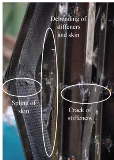
图7 加筋板不同形式的损伤形态
